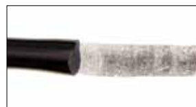
Afb. 5: Slechte hechting. Niets, of een dun laagje, is achtergebleven op de ondergrond
